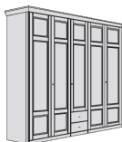
Šatní skříň 5 dveří, 2 zásuvky Také provedení s1 a 3 zrcadly Š x v x h (mm): 2605x2255x615
